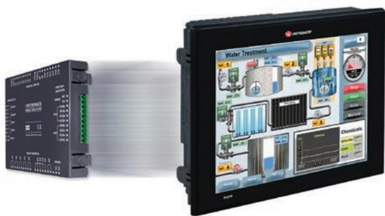
Connecter un module Snap-In directement sur un API Vision.
